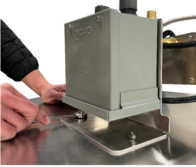
Photo 13 : Montage du transformateur sur la plaque
