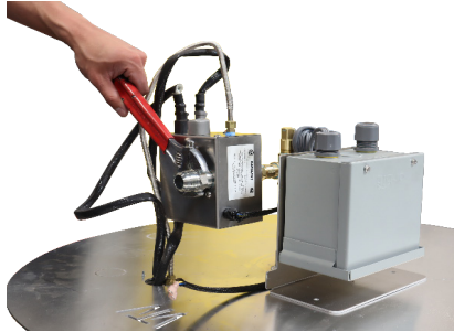
Photo 20 : Raccordement du raccord évasé à la vanne Platinum
