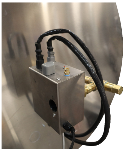
Photo 11 : Connexions électroniques du pilote à la vanne
