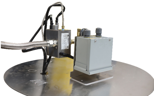
Photo 21 : Fixation de la conduite flexible
