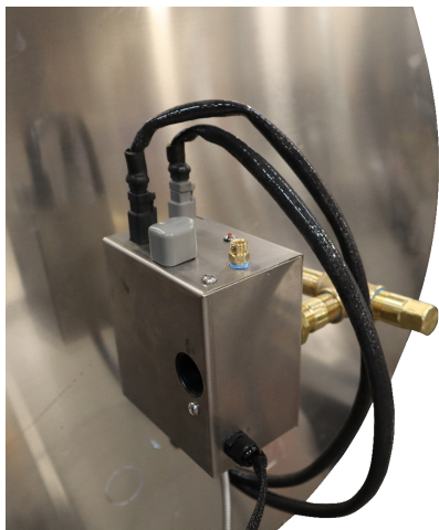
Foto 11: Conexiones electrónicas del piloto a la válvula
