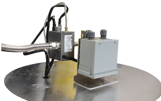
Foto 21: Conexión de la línea flexible
