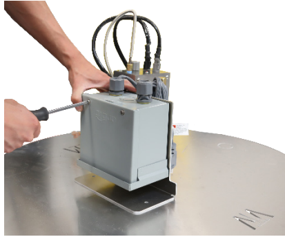
Foto 14: Extracción del panel frontal
