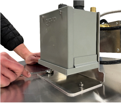
Foto 13: Montaje del transformador a la placa
