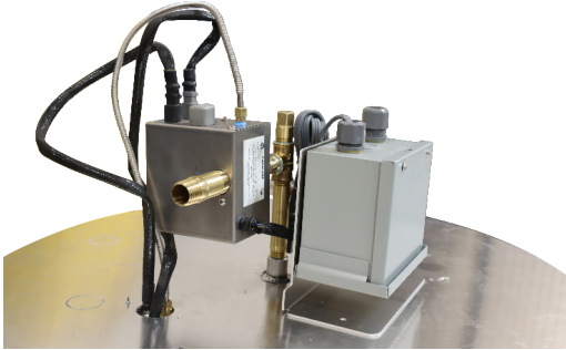
Foto 25: Conexión del nipple de 3/4 in x 3 in a la válvula de platino
